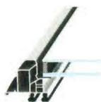
ОДНОКАМЕРНЫЙ ТЕПЛОСБЕРЕГАЮЩИЙ СТЕКЛОПАКЕТ С МАТОВОЙ ПЛЕНКОЙ ТИП W105 (6FLOAT-20AR-8VSG)
